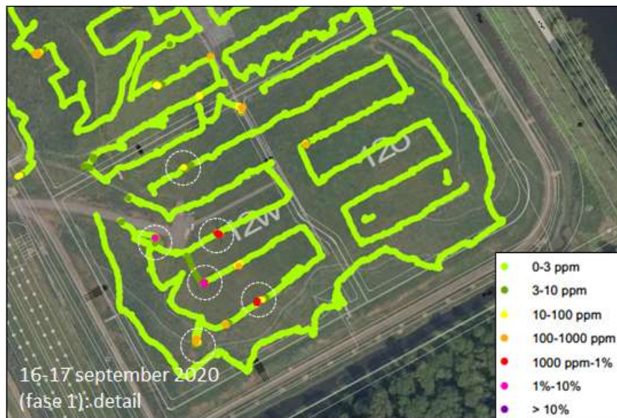
Figuur 19: Detail van Fout! Verwijzingsbron niet gevonden. (links), compartiment 12W/O met fase 1-beluchting met gedetailleerde legenda. Gemeten methaanemissie bij de bronnen waar op dat moment lucht wordt geïnjecteerd.
