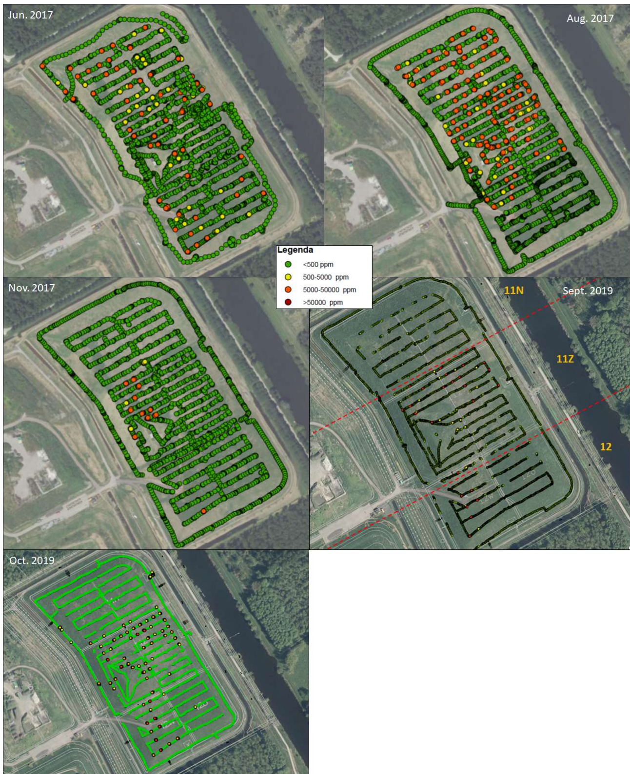
Figuur 17: Methaanscreenings van Braambergen, compartiment 11N/Z en 12 (met de klok mee van juni 2017 tot oktober 2019).
